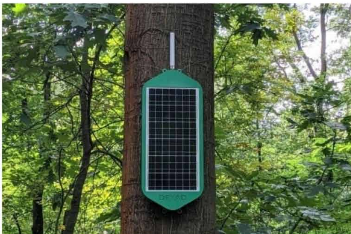
sensores IoT incendios Vodafone
